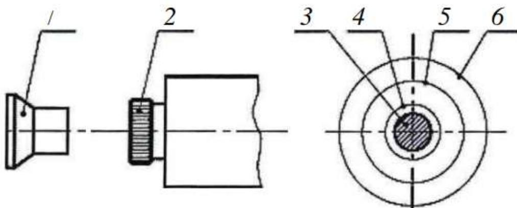
Рисунок 1 - Установка теодолита соосно с коллиматором или с автоколлиматором
